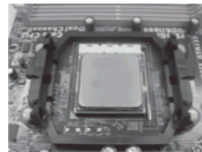
FASE 4: Abbassare e bloccare la levetta socket
