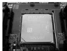
步骤 4: 下推并锁住插座拉杆
